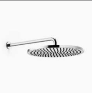
28 659 970 / 28 679 970 / 28 649 970 Regenbrause mit Wandanbindung, Ø 400/300/220 mm Regendouche met wandbevestiging, Ø 400/300/220 mm Pomme de douche arrosoir à fixation murale, Ø 400/300/220 mm [14 l/min. / 14 l/min. / 9 l/min.]
