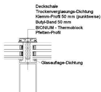
Die verwendeten Marken - Isoliergläser sind aus österreichischer Produktion. Der Wärmedurchgangskoeffizient (Ug) der Gläser beträgt je nach Anforderung bis zu 0,5 W/m<sup>2</sup>K. Unterschiedliche Materialien der Glasabstandhalter zwischen den einzelnen Gläsern (Edelstahl bzw. Kunststoff) ermöglichen eine „warme Glaskante“.
