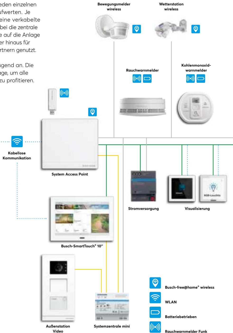
Der System Access Point ist die Schnittstelle von Busch-free@home® zum Heimnetzwerk und damit das zentrale Element der Anlage. Über ihn erfolgen Bedienung und Einrichtung per App oder Browser.
