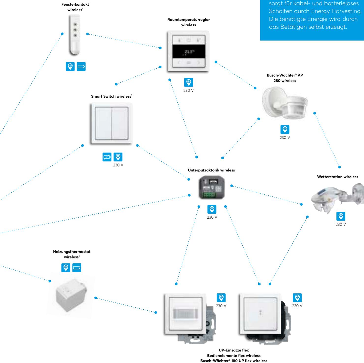
Die Installation kann auf bis zu 150 Wireless-Geräte erweitert werden.
