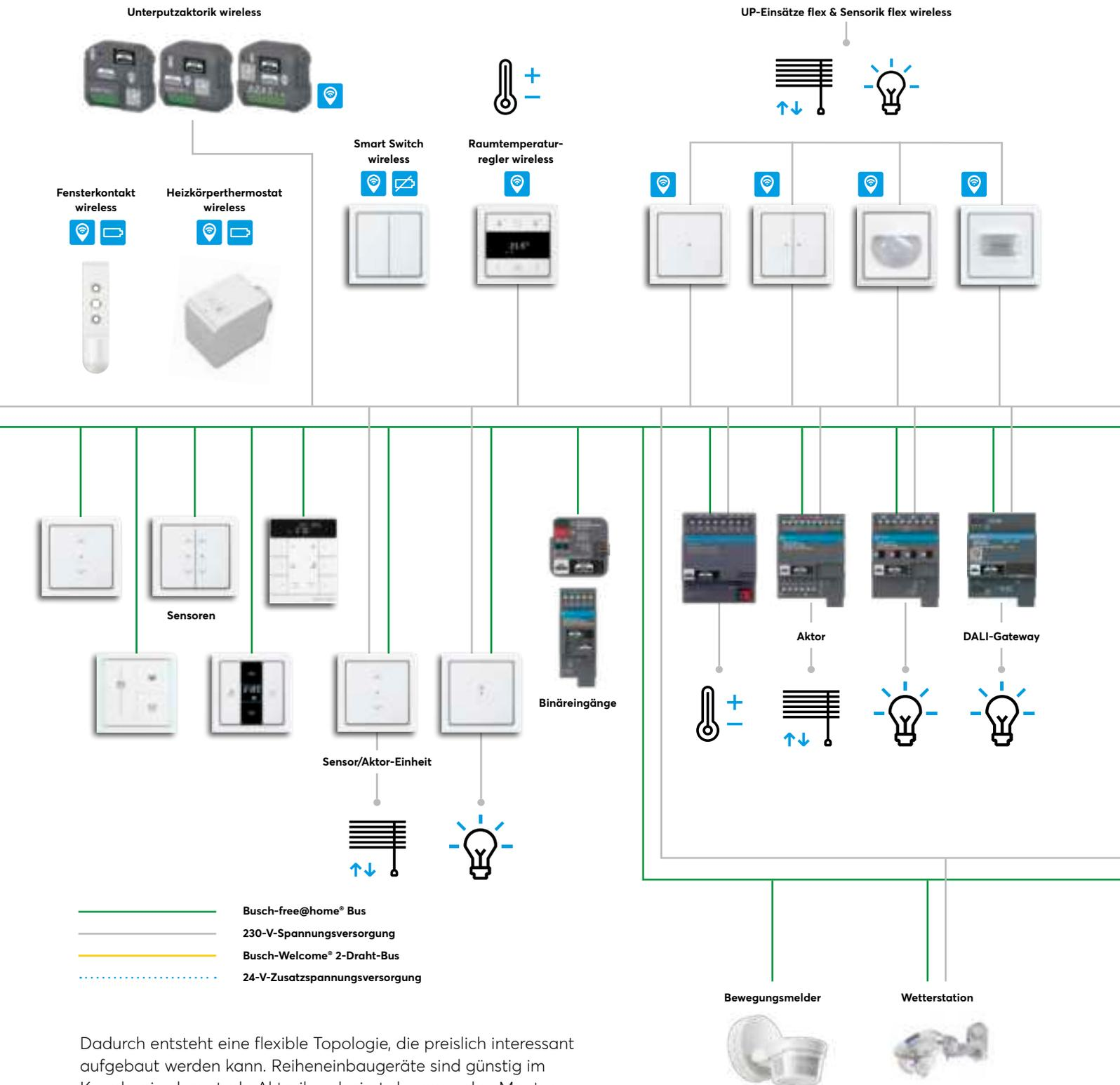
Dadurch entsteht eine flexible Topologie, die preislich interessant aufgebaut werden kann. Reiheneinbaugeräte sind günstig im Kanalpreis, dezentrale Aktorik reduziert dagegen den Montageaufwand. Durch die Flexibilität kann das System nach und nach errichtet und ausgebaut werden. Damit verteilen sich die Kosten – ohne Verluste hinsichtlich der Funktionalität.
