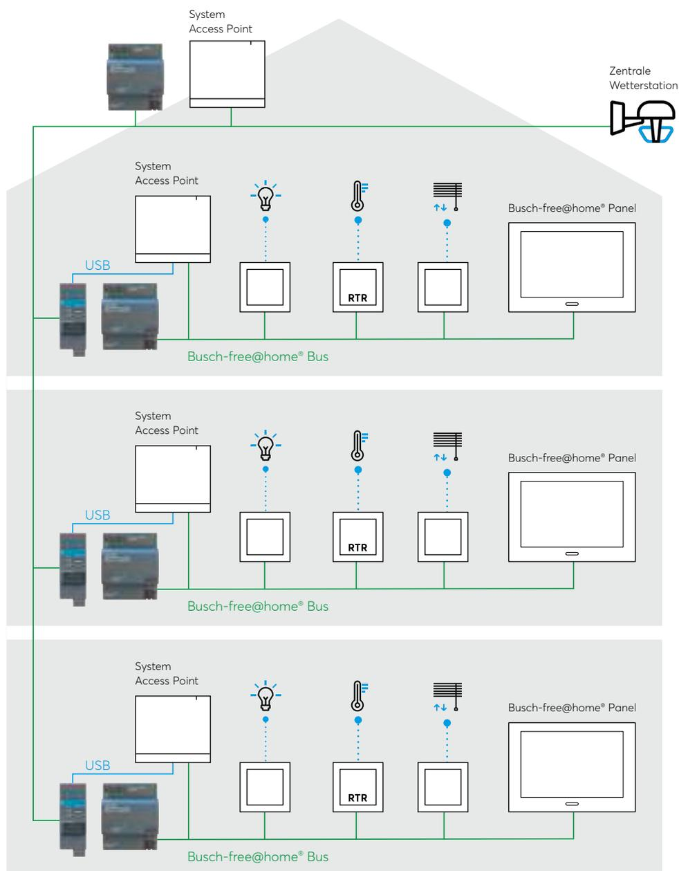
Mit der USB-Schnittstelle können eine oder mehrere Wetterstationen zentral installiert werden.
